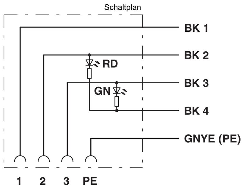
Kontaktbelegung des Ventilsteckers
