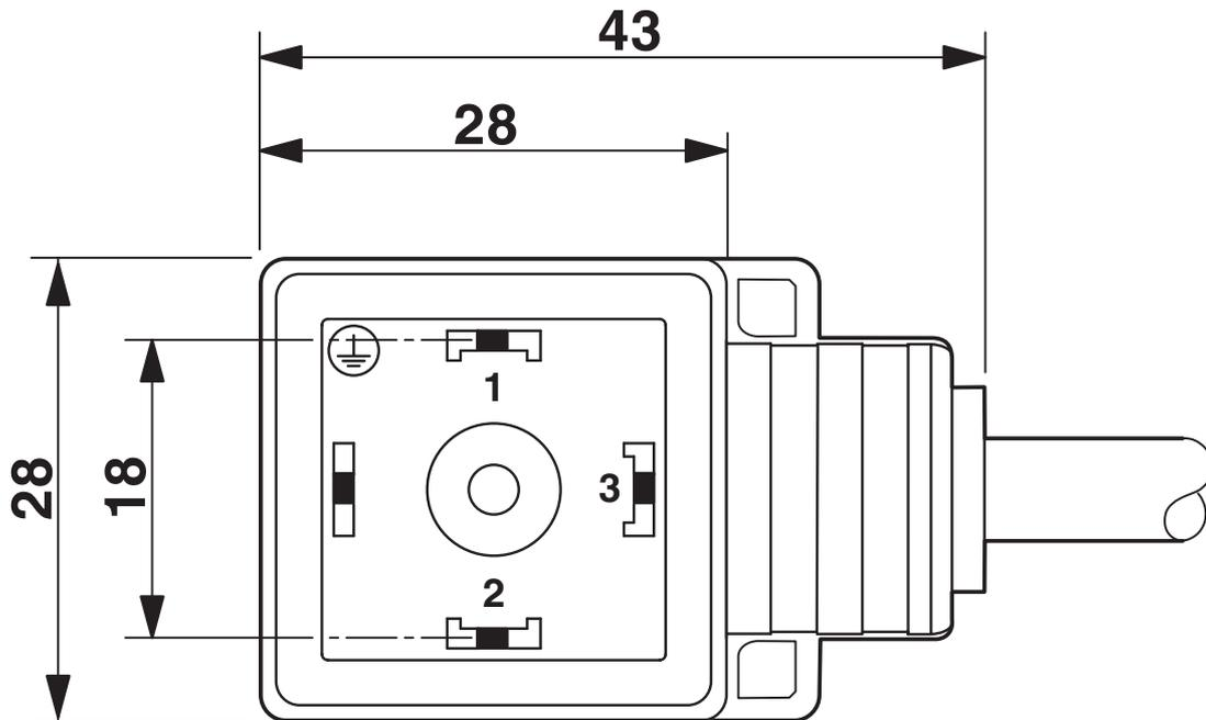
Ventilstecker, Bauform AD
