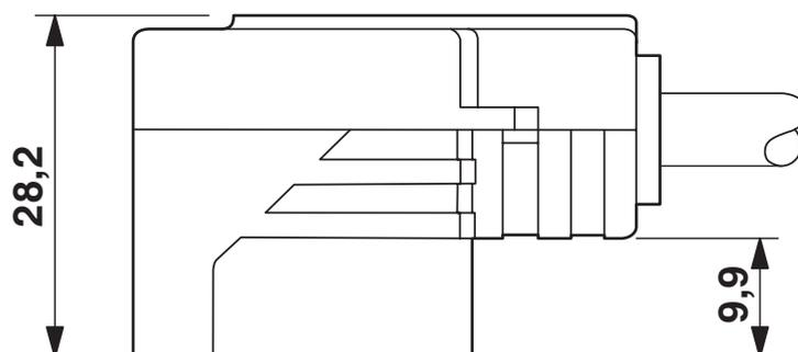
Ventilstecker, Bauform AD, Seitenansicht
