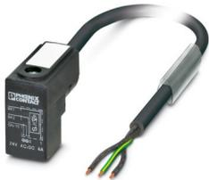
Sensor-/Aktor-Kabel, 3-polig, PVC, schwarz RAL 9005, freies Leitungsende, auf Ventilstecker C (8 mm), mit 1 LED, Beschaltung: Varistor, Kabellänge: 3 m
