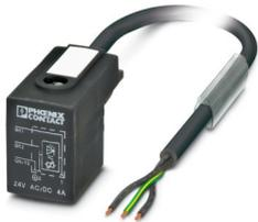
Sensor-/Aktor-Kabel, 3-polig, PVC, schwarz RAL 9005, freies Leitungsende, auf Ventilstecker BI (11 mm), mit 1 LED, Beschaltung: Varistor, Kabellänge: 10 m
