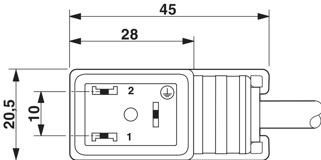
Ventilstecker, Bauform B
