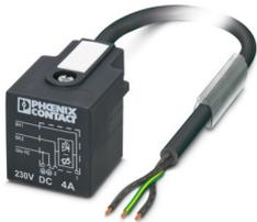
Sensor-/Aktor-Kabel, 3-polig, PVC, schwarz RAL 9005, freies Leitungsende, auf Ventilstecker A, mit 1 LED, Beschaltung: Varistor 230 V, Kabellänge: 3 m
