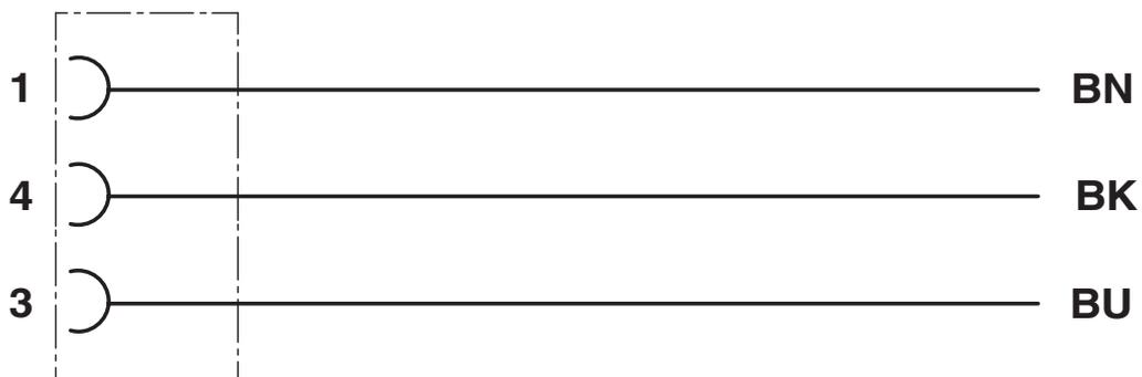
Kontaktbelegung der M8-Buchse
