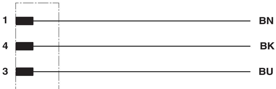
Kontaktbelegung des M8-Steckers
