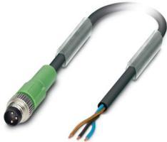
Sensor-/Aktor-Kabel, 3-polig, PVC, schwarz RAL 9005, Stecker gerade M8, Kodierung: A, auf freies Leitungsende, Kabellänge: 5 m
