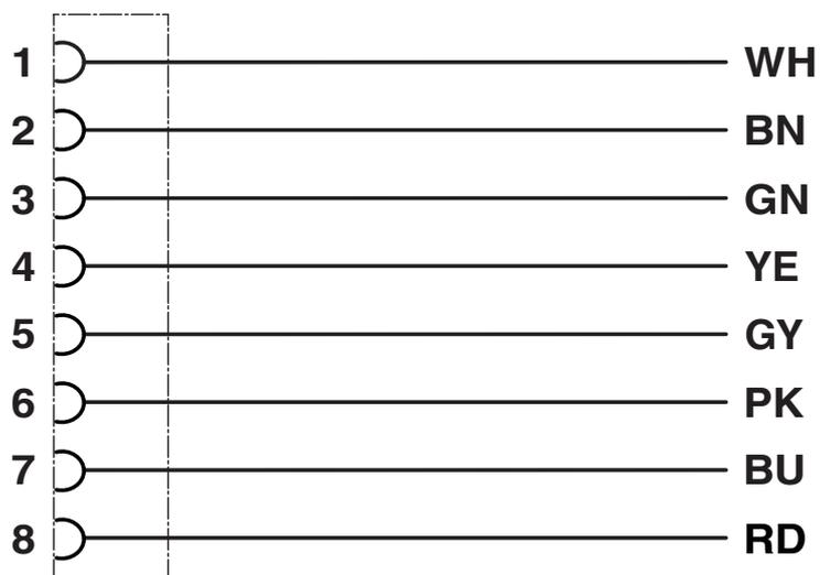
Kontaktbelegung der M12-Buchse
