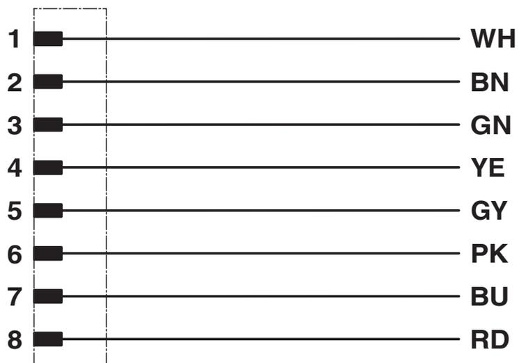
Kontaktbelegung des M12-Steckers
