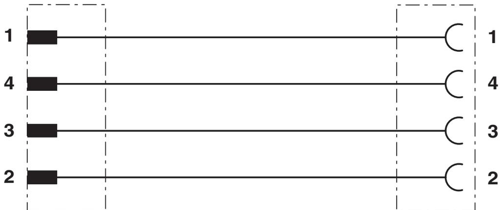
Kontaktbelegung der M12-Stecker / M8-Buchse
