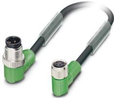
Sensor-/Aktor-Kabel, 4-polig, PVC, schwarz RAL 9005, Stecker gewinkelt M12, Kodierung: A, auf Buchse gewinkelt M8, Kodierung: A, Kabellänge: 1,5 m
