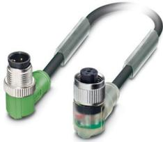
Sensor-/Aktor-Kabel, 4-polig, PVC, schwarz RAL 9005, Stecker gewinkelt M12, Kodierung: A, mit 3 LEDs, auf Buchse gewinkelt M12, Kodierung: A, mit 3 LEDs, Kabellänge: 0,3 m
