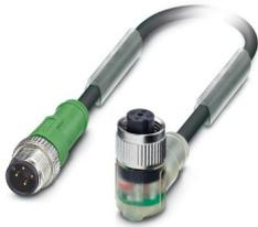
Sensor-/Aktor-Kabel, 4-polig, PVC, schwarz RAL 9005, Stecker gerade M12, Kodierung: A, mit 3 LEDs, auf Buchse gewinkelt M12, Kodierung: A, mit 3 LEDs, Kabellänge: 0,3 m
