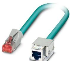
Konfektioniertes Ethernet-Kabel, CAT6, geschirmt, 4-paarig, AWG 26\* flexibel (7-drähtig), RAL 5021 (wasserblau), RJ45-Buchsenmodul/IP20 für Freenet-System, 8-polig auf RJ45-Stecker/IP20, Line, Länge 2 m
