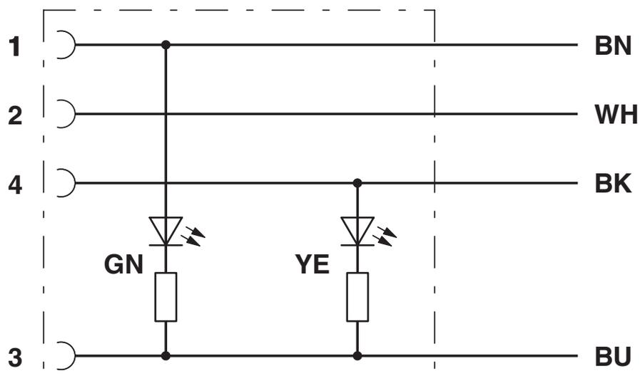
Kontaktbelegung der M8-/M12-Buchse mit LED
