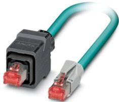
Konfektioniertes Ethernet-Kabel, CAT6, geschirmt, 4-paarig, AWG 26\* flexibel (7-drähtig), RAL 5021 (wasserblau), RJ45-Stecker/IP67 Push-Pull Kunststoffgehäuse auf RJ45-Stecker/IP20, Line, Länge 5 m
