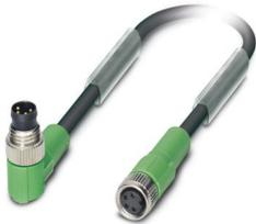
Sensor-/Aktor-Kabel, 4-polig, PVC, schwarz RAL 9005, Stecker gewinkelt M8, Kodierung: A, auf Buchse gerade M8, Kodierung: A, Kabellänge: 0,6 m
