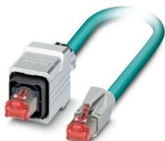
Konfektioniertes Ethernet-Kabel, CAT6, geschirmt, 4-paarig, AWG 26\* flexibel (7-drähtig), RAL 5021 (wasserblau), RJ45-Stecker/IP67 Push-Pull Metallgehäuse auf RJ45-Stecker/IP20, Line, Länge 5 m
