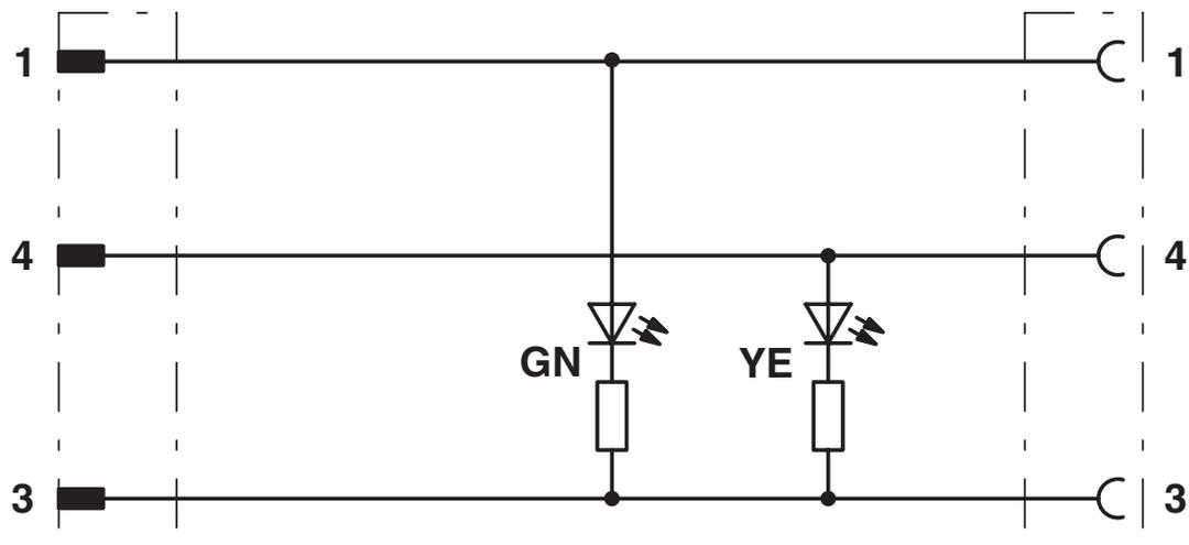
Kontaktbelegung des M12-Stecker und der M12-Buchse
