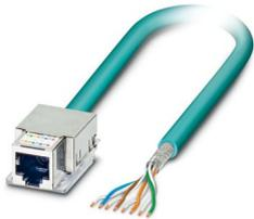
Konfektioniertes Ethernet-Kabel, CAT6, geschirmt, 4-paarig, AWG 26\* flexibel (7-drähtig), RAL 5021 (wasserblau), RJ45-Buchsenmodul/IP20 für Freenet-System, 8-polig auf freies Leitungsende, Line, Länge 2 m
