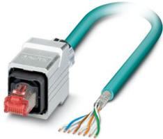
Konfektioniertes Ethernet-Kabel, CAT6, geschirmt, 4-paarig, AWG 26\* flexibel (7-drähtig), RAL 5021 (wasserblau), RJ45-Stecker/IP67 Push-Pull Metallgehäuse auf freies Leitungsende, Line, Länge 5 m
