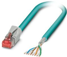
Konfektioniertes Ethernet-Kabel, CAT6, geschirmt, 4-paarig, AWG 26\* flexibel (7-drähtig), RAL 5021 (wasserblau), RJ45-Stecker/IP20 auf freies Leitungsende, Line, Länge 2 m
