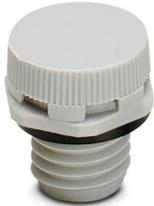
Druckausgleichselement, Material Verschraubung: PA, Anschlussgewinde: M12 x 1,5, Farbe: lichtgrau, mit O-Ring
