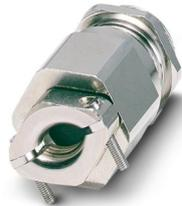
Kabelverschraubung, Material Verschraubung: Messing, vernickelt, Anwendung: Standard, Kabelaußendurchmesser 16 mm ... 28 mm, Schirmung: nein, Anschlussgewinde: M40 x 1,5, Farbe: silberfarben, mit externer Zugentlastung, mit O-Ring
