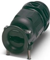
Kabelverschraubung, Material Verschraubung: PA, Anwendung: Standard, Kabelaußendurchmesser 13 mm ... 21 mm, Schirmung: nein, Anschlussgewinde: M32 x 1,5, Farbe: tiefschwarz, mit externer Zugentlastung
