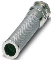
Kabelverschraubung, Material Verschraubung: Messing, vernickelt, Anwendung: Standard, Kabelaußendurchmesser 9 mm ... 17 mm, Schirmung: nein, Anschlussgewinde: M25 x 1,5, Farbe: silberfarben, mit Knickschutz, mit O-Ring
