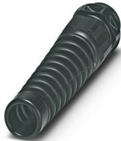
Kabelverschraubung, Material Verschraubung: PA, Anwendung: Standard, Kabelaußendurchmesser 3 mm ... 7 mm, Schirmung: nein, Anschlussgewinde: M12 x 1,5, Farbe: tiefschwarz RAL 9005, mit Knickschutz
