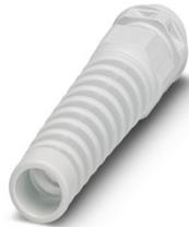
Kabelverschraubung, Material Verschraubung: PA, Anwendung: Standard, Kabelaußendurchmesser 3 mm ... 7 mm, Schirmung: nein, Anschlussgewinde: M12 x 1,5, Farbe: lichtgrau RAL 7035, mit Knickschutz
