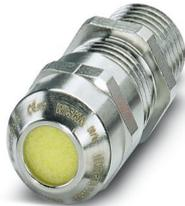
Kabelverschraubung, Material Verschraubung: Messing, vernickelt, Anwendung: Ex, Kabelaußendurchmesser 5 mm ... 10 mm, Schirmung: ja, Anschlussgewinde: M16 x 1,5, Farbe: silberfarben, mit O-Ring
