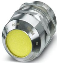
Kabelverschraubung, Material Verschraubung: Messing, vernickelt, Anwendung: Ex, Kabelaußendurchmesser 21 mm ... 35 mm, Schirmung: nein, Anschlussgewinde: M50 x 1,5, Farbe: silberfarben, mit O-Ring
