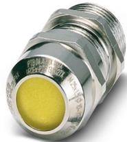
Kabelverschraubung, Material Verschraubung: Messing, vernickelt, Anwendung: Ex, Kabelaußendurchmesser 13 mm ... 21 mm, Schirmung: nein, Anschlussgewinde: M32 x 1,5, Farbe: silberfarben, mit O-Ring
