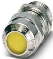
Kabelverschraubung, Material Verschraubung: Messing, vernickelt, Anwendung: Ex, Kabelaußendurchmesser 6 mm ... 13 mm, Schirmung: nein, Anschlussgewinde: M20 x 1,5, Farbe: silberfarben, mit O-Ring
