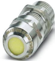
Kabelverschraubung, Material Verschraubung: Messing, vernickelt, Anwendung: Ex, Kabelaußendurchmesser 5 mm ... 10 mm, Schirmung: nein, Anschlussgewinde: M16 x 1,5, Farbe: silberfarben, mit O-Ring
