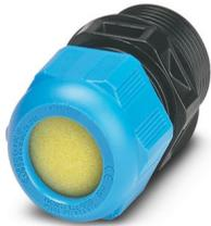
Kabelverschraubung, Material Verschraubung: PA, Anwendung: Ex, Kabelaußendurchmesser 13 mm ... 21 mm, Schirmung: nein, Anschlussgewinde: M32 x 1,5, Farbe: schwarz/blau, mit Flachdichtung
