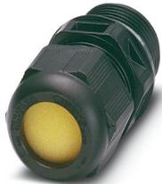
Kabelverschraubung, Material Verschraubung: PA, Anwendung: Ex, Kabelaußendurchmesser 23 mm ... 35 mm, Schirmung: nein, Anschlussgewinde: M50 x 1,5, Farbe: tiefschwarz, mit Flachdichtung
