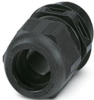
Kabelverschraubung, Material Verschraubung: PA, Anwendung: Ex, Kabelaußendurchmesser 17 mm ... 28 mm, Schirmung: nein, Anschlussgewinde: M40 x 1,5, Farbe: tiefschwarz, mit Flachdichtung
