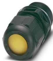
Kabelverschraubung, Material Verschraubung: PA, Anwendung: Ex, Kabelaußendurchmesser 13 mm ... 21 mm, Schirmung: nein, Anschlussgewinde: M32 x 1,5, Farbe: tiefschwarz, mit Flachdichtung
