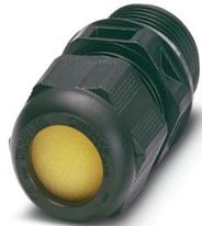
Kabelverschraubung, Material Verschraubung: PA, Anwendung: Ex, Kabelaußendurchmesser 7 mm ... 13 mm, Schirmung: nein, Anschlussgewinde: M20 x 1,5, Farbe: tiefschwarz, mit Flachdichtung
