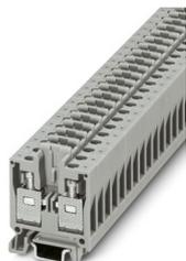
Trennklemme, Strom und Spannung werden durch den eingesetzten Stecker bestimmt., Nennspannung: 500 V, Nennstrom: 16 A, Anschlussart: Schraubanschluss, Bemessungsquerschnitt: 4 mm<sup>2</sup>, Querschnitt: 0,2 mm<sup>2</sup> - 4 mm<sup>2</sup>, Montage: NS 15, Farbe: grau
