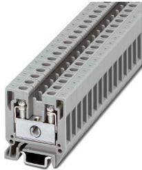
Minidurchgangsklemme, Nennspannung: 500 V, Nennstrom: 32 A, Anzahl der Anschlüsse: 2, Anschlussart: Schraubanschluss, 1. Etage, Querschnitt: 0,2 mm<sup>2</sup> - 4 mm<sup>2</sup>, Montageart: NS 15, Farbe: grau
