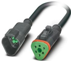
Sensor-/Aktor-Kabel, 3-polig, PUR halogenfrei, schwarzgrau RAL 7021, Stecker gerade DEUTSCH DT04-3P Clipverriegelung, Kodierung: A, Beschaltung: unbeschaltet, auf Buchse gerade DEUTSCH DT06-3S Clipverriegelung, Beschaltung: unbeschaltet, Kabellänge: 3 m
