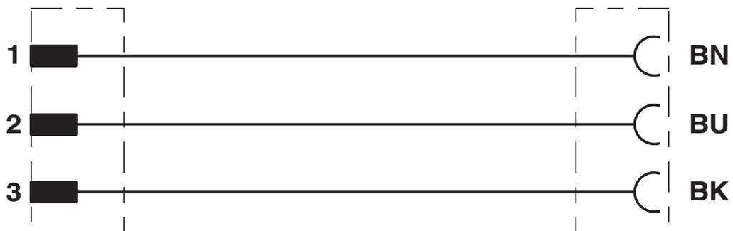
Kontaktbelegung der DEUTSCH-Steckverbinder
