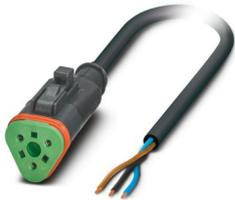
Sensor-/Aktor-Kabel, 3-polig, PUR halogenfrei, schwarzgrau RAL 7021, freies Leitungsende, auf Buchse gerade DEUTSCH DT06-3S Clipverriegelung, Kodierung: A, Beschaltung: unbeschaltet, Kabellänge: 5 m
