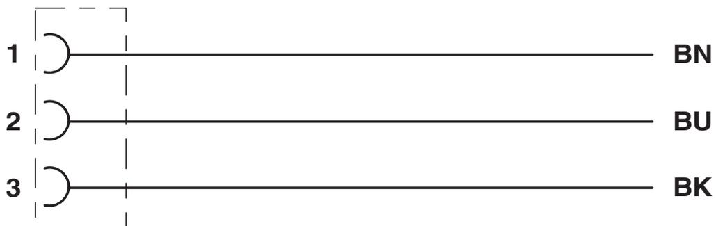
Kontaktbelegung des DEUTSCH DT06-3S
