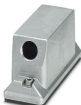
HEAVYCON ADVANCE-Tüllengehäuse, B24, mit Schraubverriegelung (Innensechskant) aus Edelstahl, seewasserbeständiges Aluminium, Höhe 74 mm, mit Gewinde, 1x M25, seitlicher Kabelabgang, ohne Oberfläche, leitfähige Dichtung (EMV-Eigenschaften)
