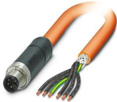
Powerleitung, 6-polig, PVC, orange RAL 2003, geschirmt (Advanced Shielding Technology), Stecker gerade M12, Kodierung: M, auf freies Leitungsende, Kabellänge: 3 m, für Wechselstrom bis 8 A/690 V
