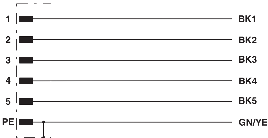
Kontaktbelegung des M12-Steckers
