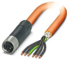
Powerleitung, 6-polig, PUR halogenfrei, orange RAL 2003, geschirmt (Advanced Shielding Technology), freies Leitungsende, auf Buchse gerade M12, Kodierung: M, Kabellänge: 3 m, für Wechselstrom bis 8 A/690 V
