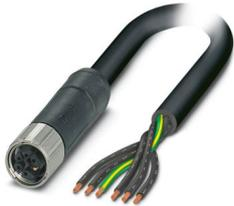
Powerleitung, 6-polig, PUR halogenfrei, schwarzgrau RAL 7021, freies Leitungsende, auf Buchse gerade M12, Kodierung: M, Kabellänge: 3 m, für Wechselstrom bis 8 A/690 V
