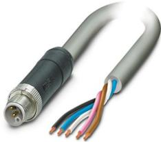
Powerleitung, 5-polig, PVC, grau RAL 7001, Stecker gerade M12, Kodierung: L, auf freies Leitungsende, Kabellänge: 10 m, für Gleichstrom bis 16 A / 63 V
