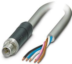
Powerleitung, 5-polig, PUR halogenfrei, grau RAL 7001, Stecker gerade M12, Kodierung: L, auf freies Leitungsende, Kabellänge: 10 m, für Gleichstrom bis 16 A / 63 V
